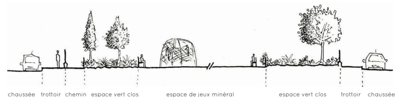
Fig. 14 : Coupe transversale de l'aire de jeux (éch. 1/200)
